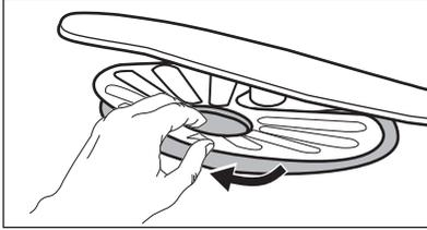
4. Reinigen Sie die Filter.
