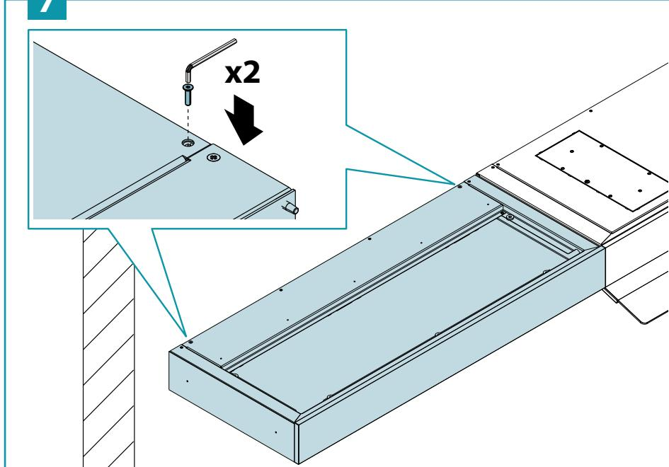
**IT** - Fissare la mensola alla cappa, in base al lato di accoppiamento (8). Montare il coperchio (9). Montare i tamponamenti laterali (10).
