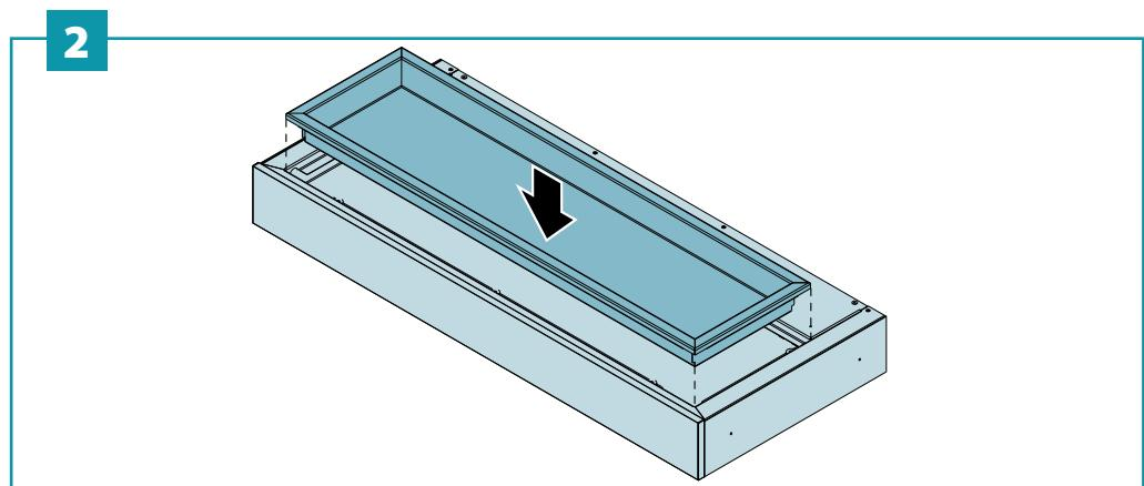
IT - Installazione del modulo accessorio in abbinamento alla cappa in versione aspirante
