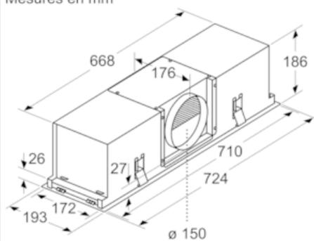
Le manchon de raccordement peut être déplacé en fonction de la situation d'installation.
