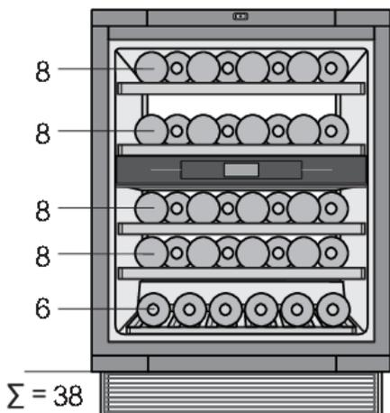
La configuration de base de l'appareil permet de stocker jusqu'à 38 bouteilles format Bordeaux.
