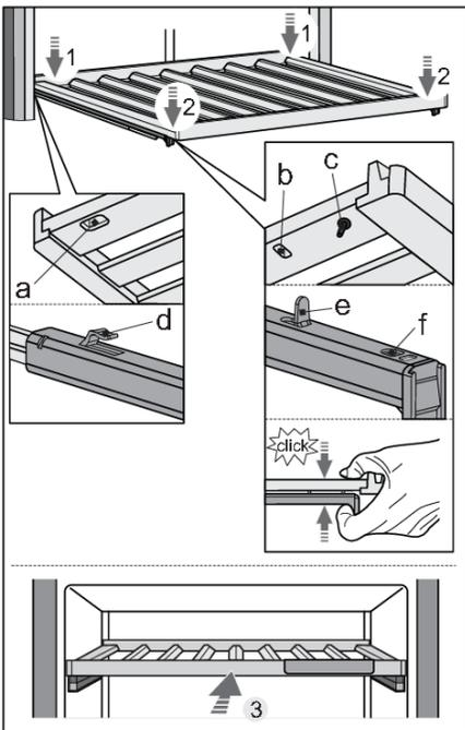
Pour replacer une étagère sur les rails, utilisez les rainures (a, b) et la goupille (c) à l'arrière et à l'avant de l'étagère.
