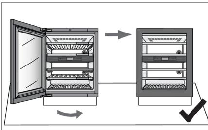
4. L'appareil et la porte doivent être parallèles.
