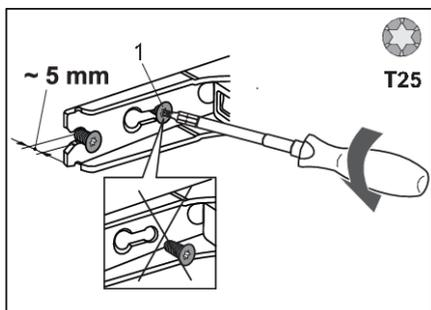
2. Dévissez partiellement (de 5 mm maximum) les vis des charnières (1) en haut et en bas. Ne dévissez pas complètement les vis. De cette façon, la porte restera en contact avec le boîtier.
