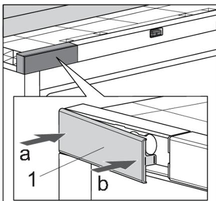
8. Remettez en place le couvercle supérieur du boîtier de la charnière supérieure (1). Poussez d'abord dans le sens de la flèche « a » puis de la flèche « b ».
