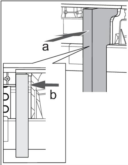
11. Poussez le séparateur de flux d'air en mousse dans le sens des flèches « a » et « b ».
