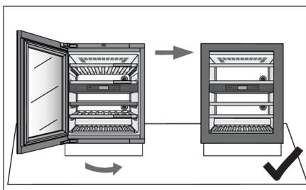
14. Fermez la porte et assurez-vous qu'elle est bien alignée avec le châssis. Le côté du châssis et le bord de la porte doivent être parallèles.
