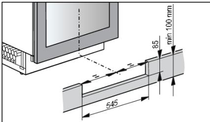
15. Préparez la plinthe. La découpe dans la plinthe pour la grille de ventilation doit être centrée avec l'appareil. C'est le seul moyen d'assurer le bon fonctionnement de l'appareil.
