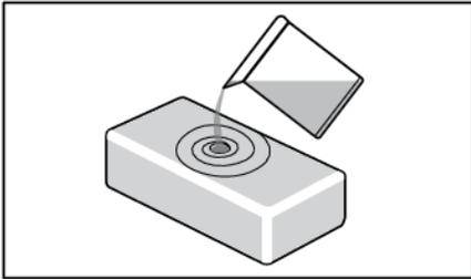
Remplir la boîte avec 0,5 litre d'eau du robinet et la placer dans la zone appropriée. Il n'y a pas de positions préférables, tant qu'elle est placée dans la bonne zone.
