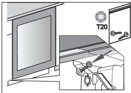
7. Fixez l'appareil à l'élément de cuisine adjacent en bas, sur le côté opposé de la charnière.
