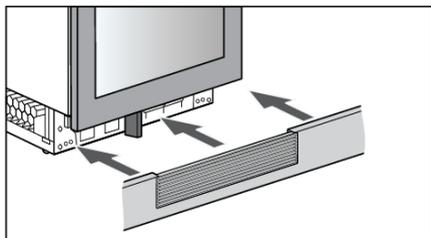
17. Assemblez la plinthe avec la grille de ventilation. L'installation de l'appareil est terminée.
