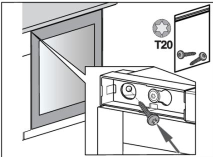
6. Fixez l'appareil à l'élément de cuisine adjacent – d'abord dans le coin supérieur gauche.
