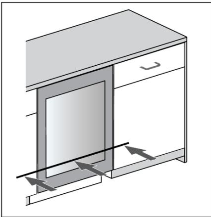
5. Poussez l'appareil dans la niche jusqu'à ce que la surface avant de la porte soit alignée avec la porte du meuble de cuisine.
