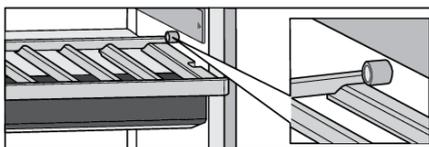
La clayette peut être partiellement étendue (retirée de l'appareil). Les blocs sur la cellule empêchent la clayette d'être entièrement étendue et retirée, éliminant ainsi les risques que celle-ci ne tombe de l'appareil.
