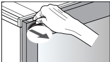
En cas de panne de courant, lorsque le mécanisme push-to-open ne fonctionne pas, la poignée cachée vous permet d'ouvrir la porte.
