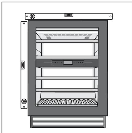
2. L'appareil doit être aligné horizontalement et verticalement, sinon il pourrait se déformer et il ne sera pas possible de fermer la porte correctement.
