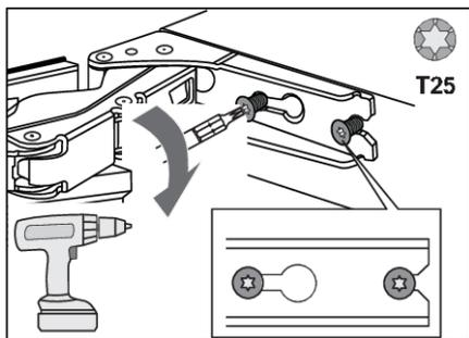
13. Serrez les vis. Les vis doivent être serrées à un couple de 6,2 Nm.
