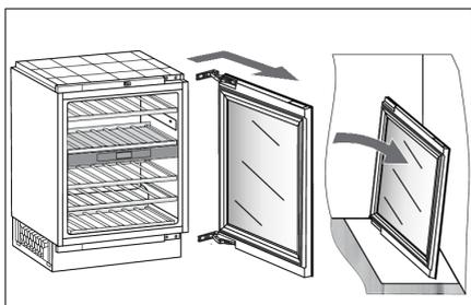
3. Retirez la porte, avec ses charnières, en la déplaçant dans le sens indiqué par la flèche. Placez soigneusement la porte sur la surface préparée à cet effet.
