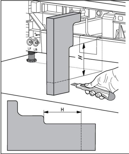
10. Mesurez la dimension « H » sur l'appareil, puis coupez le séparateur de flux d'air en mousse conformément à l'illustration.
