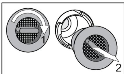
Pour remplacer le filtre à air :
