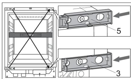
9. Prenez les boîtiers de charnière déjà retirés (3, 5) et, en suivant un schéma en diagonal, mettez-les en place en les faisant glisser.
