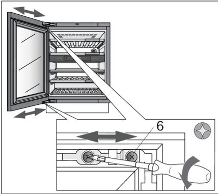
2. Dévissez les vis partiellement (6) en haut et en bas. Ne les dévissez pas complètement ! Alignez la porte sur le côté et resserrez les vis.
