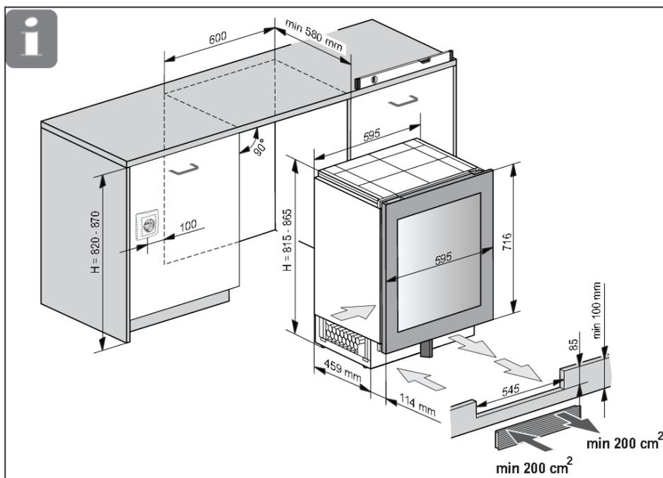
La ventilation de l'appareil s'effectue à travers les grilles situées à sa base. Celles-ci ne doivent pas être obstruées. En outre, les grilles doivent être dépoussiérées régulièrement.
