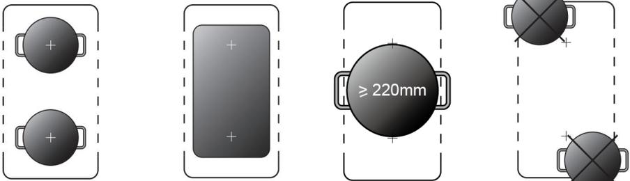
1. Activation de la zone flexible : Appuyer sur la touche "5" de zones en même temps active la zone flexible. Le réglage de la puissance fonctionne comme n'importe quelle autre zone normale.
