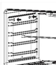
2. Tirez le support d'accrochage légèrement vers le bas et insérez les crochets inférieurs dans les trous de perçage.
