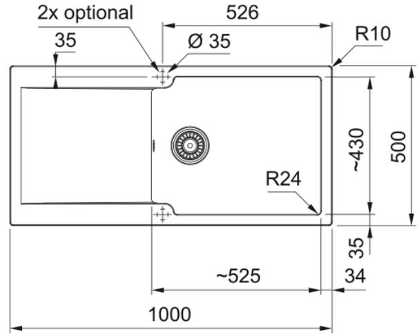
Evier KITE , KITE 611-100 Noir, à encastrer 1000x500 mm. Sa matière Tectonite avec sa surface non poreuse facilite le nettoyage et garantit une hygiène maximale. Vidage manuel, trop plein rond avec sa bonde, tous ces accessoires qui permettent une installation en toute tranquillité.
