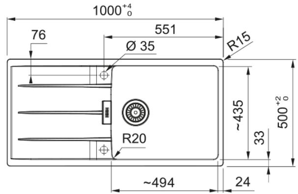
Evier CENTRO, CNG 611-XL Stone, à encastrer 1000x500 mm. Sa matière Fraganite résiste aux rayures, aux chocs et aux taches. Vidage manuel, Trop plein desing inox avec sa bonde tous ces accessoires qui permettent une installation en toute tranquillité.
