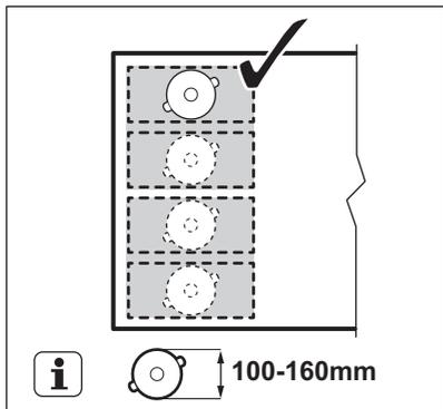
Coloque los utensilios de cocina con diámetro inferior de 160 mm centrados entre dos secciones.
